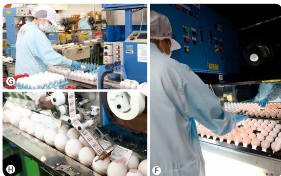
GPセンターの様子(写真F・G・H)。機械と人の目両方で、何度も確認しています
