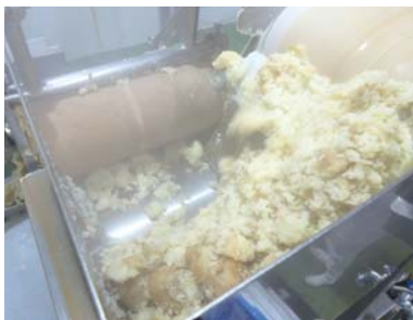
蒸し上げたじゃがいもを、機械で皮と身に分け網で裏ごしします
