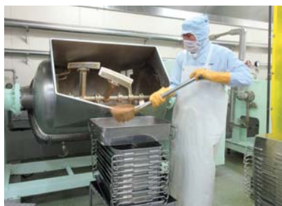
炒めたたまねぎと調味料・肉を混ぜたものをバットに入れ、冷却して細菌の増殖を防ぎます
