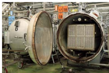
蒸し上げに使う機械。一度に最大5,500缶を蒸すことができます
