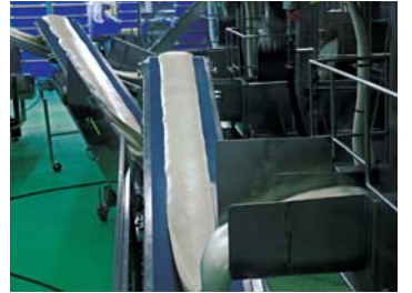
きねつき機から出てきた餅。ここから餅がコンベアを8m流れていくのを見えています
